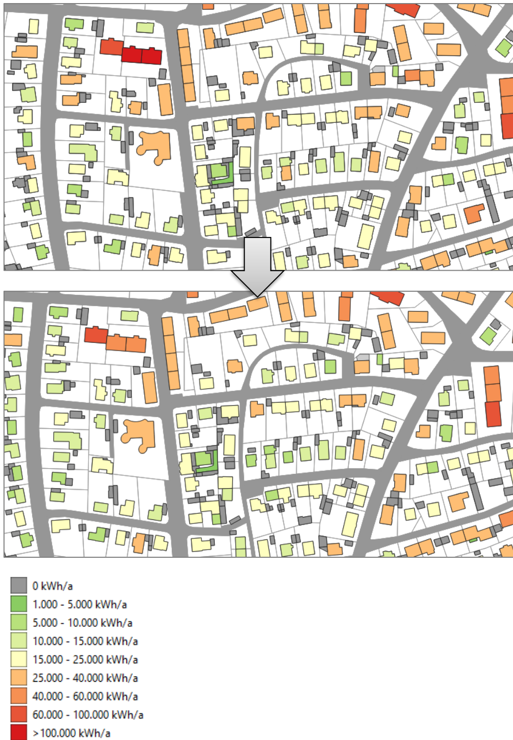
Abbildung 15: Beispielhafter Ausschnitt eines Sanierungskatasters vor und nach der Sanierung im Szenario 2030
