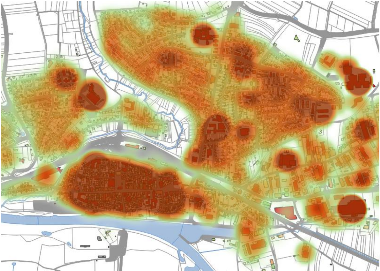
Abbildung 2: Exemplarisches Beispiel eines Wärmekatasters inklusive Wärmedichten-Darstellung
