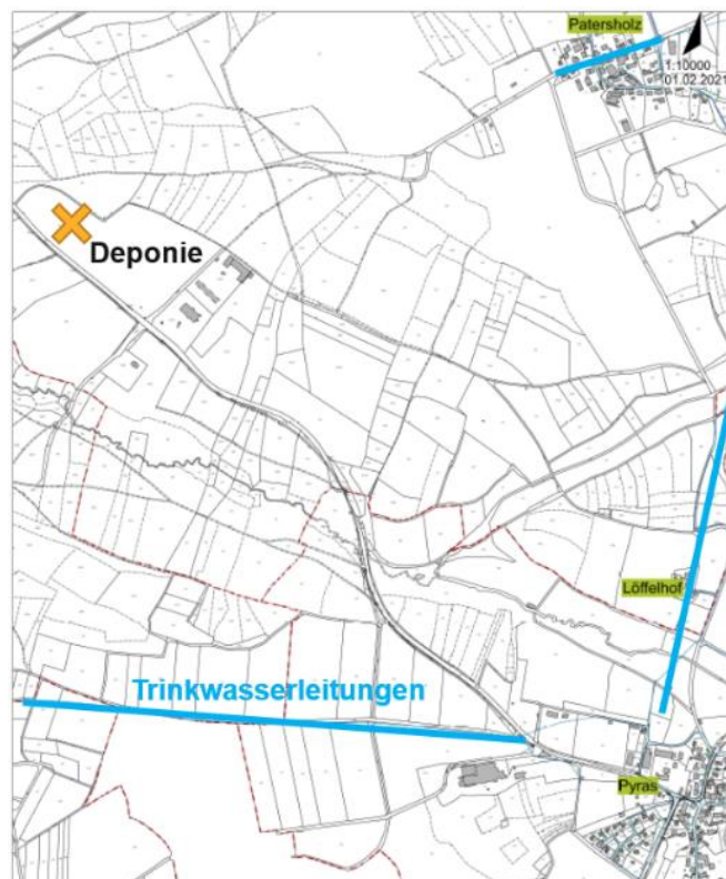
Abbildung 33: Skizze Trinkwasserleitungen in der Umgebung der Deponie Pyras
